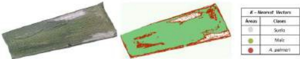
Figura 2: Mapa de clasificación supervisada elaborado mediante el algoritmo K-nearest vector implementado en el software Q-Gis
